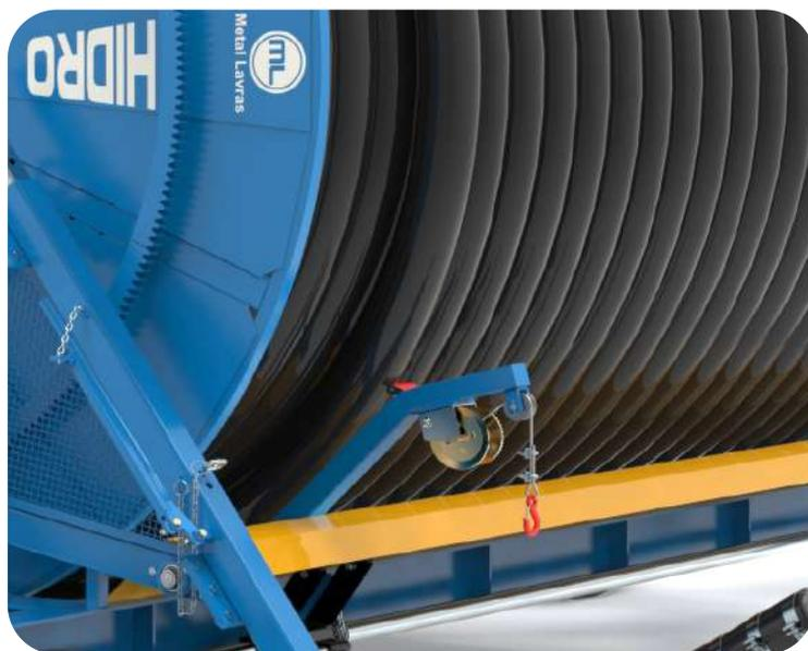
Equipamento simples e robusto, composto de carretel montado sobre chassi de dois eixos, tendo acionamento por pinhão e cremalheira através de um redutor de duas velocidades ligado à tomada de força de qualquer trator por eixo cardan.
